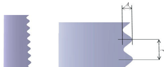
图7 桨叶后缘锯齿参数定义
